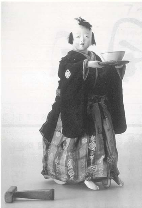
茶運び人形 (石川県 平戸善一郎氏蔵) 動力は鯨のひげゼンマイで、内部は全て木製。
