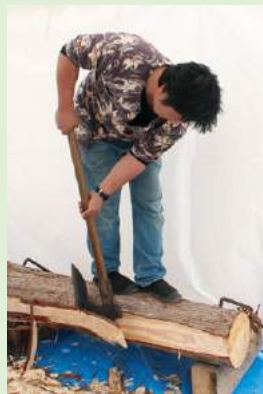
ハツリで木材の側面を落とし、 角材にする。失われ行く杢の技
