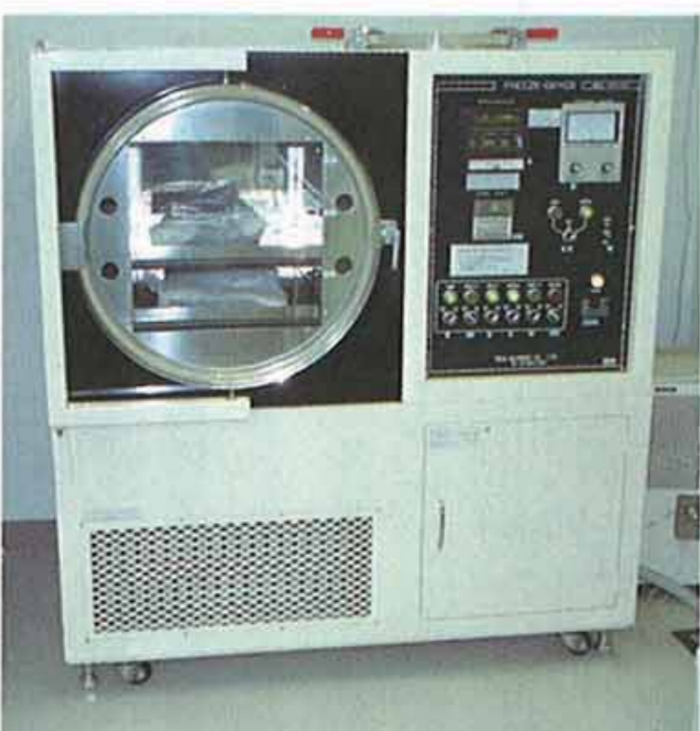
凍結真空乾燥機で処理中の水濡れ文書
